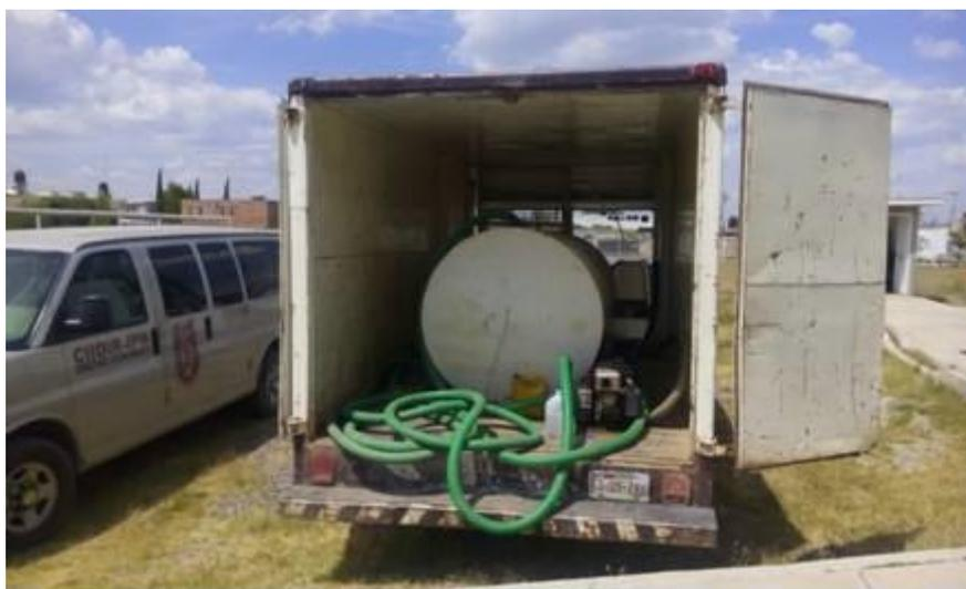
Figura 2. Implemento para el riego con agua tratada de las áreas verdes del centro.
